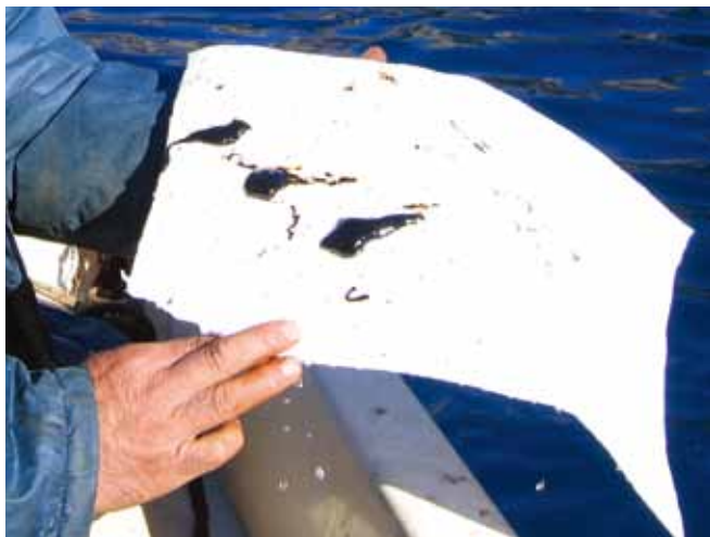
▲ 图 6：使用清洁的吸油垫捕获漂浮油。
