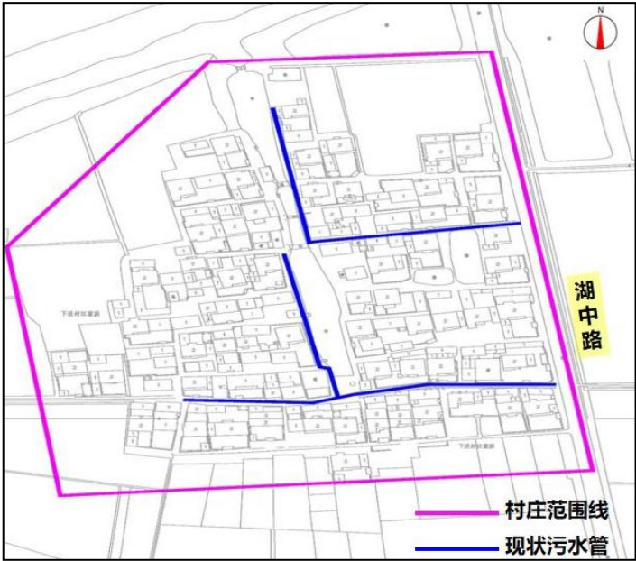
图2.7-9 江家浜污水管网现状
