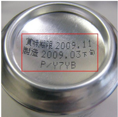
罐体底部喷码机打印产品信息
