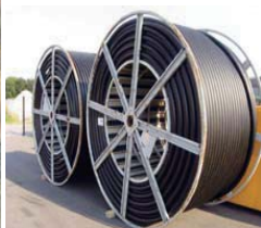
如图：可以直接通过管道滚轴铺设管道，缩短施工周期，节省施工成本。
