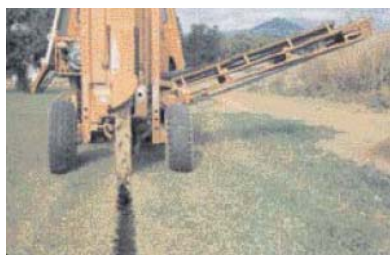
如图：使用小型挖掘机可以在非常狭窄的区域内进行工作。这不仅可以节省管道安装的成本，还可以减少对交通造成的影响。
