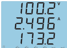
图3-5相电压、相电流、线电压平均值显示
