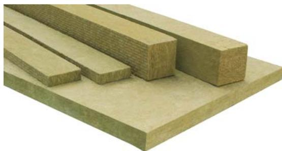
樱花船用复合板用岩棉（SL 系列、SR 系列）是专为船用复合板而开发的芯材，具有出色的抗压和抗拉性能，具有极低的吸水率和吸湿率，燃烧性能为不燃。SL 系列是沿着 SR 系列的长度方向切割而成。使用时 SL 系列的纤维方向应垂直于金属板，从而可获得更高的机械强度和更平整的表面。
