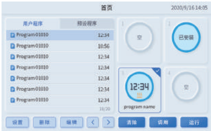
组织处理管、加热套安装在位提示
