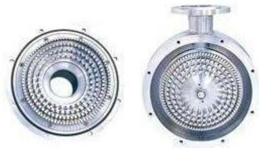
LHM1 均质乳化泵是的泵腔内装有一组双层定子和双层转子，转子传动轴采用高强度 316 材料，密封装置为水冷却双端面机械密封。泵轴由轴承箱支撑，通过联轴器与电机相连。该产品的工作原理是将物料从进口吸入，进行全面均质乳化后从出口排出。
