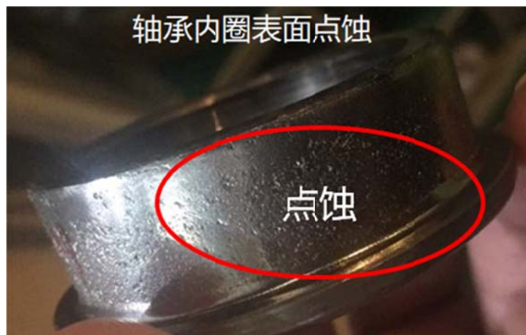
图3 某挖掘柱塞泵前泵轴承
