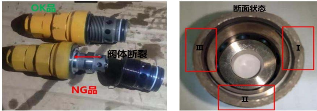
图2 某挖掘多路阀下方溢流阀断裂
