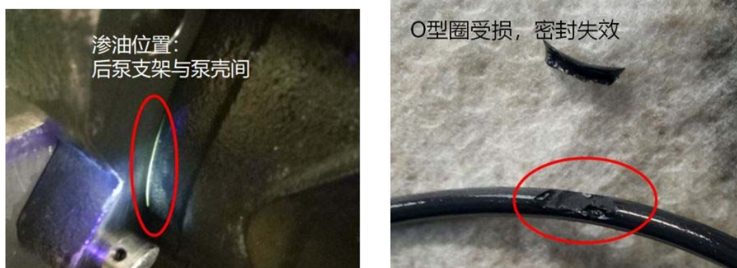
图1 某挖掘柱塞泵密封失效漏油
