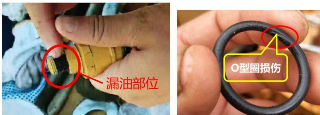
图1 某挖掘多路阀密封失效漏油
