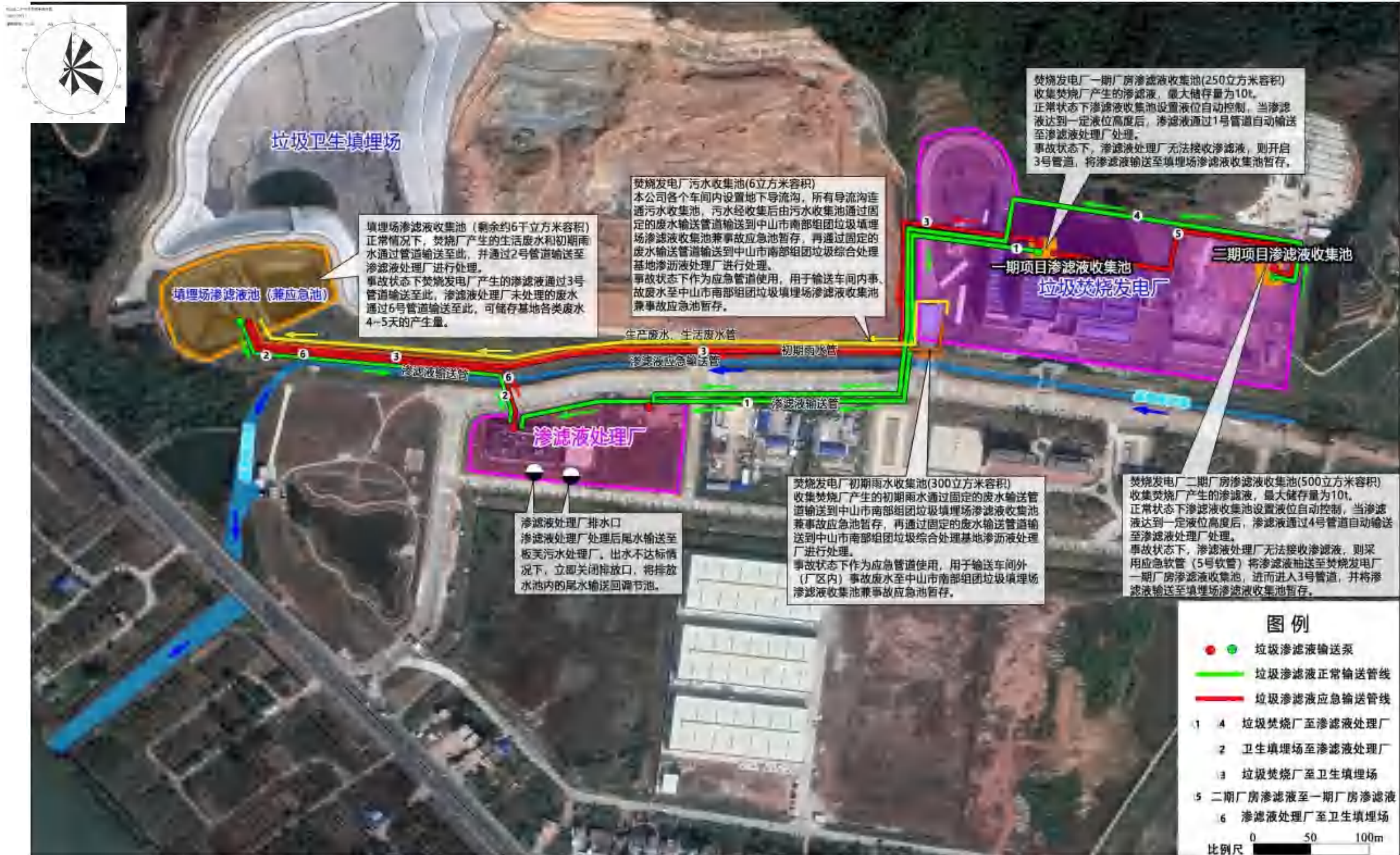
图 6.9-9 本项目事故废水收集管网图
