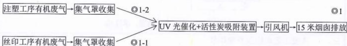
图 3-1-1 注塑、丝印工序有机废气处理流程及采样点位示意图(◎为采样位点)
