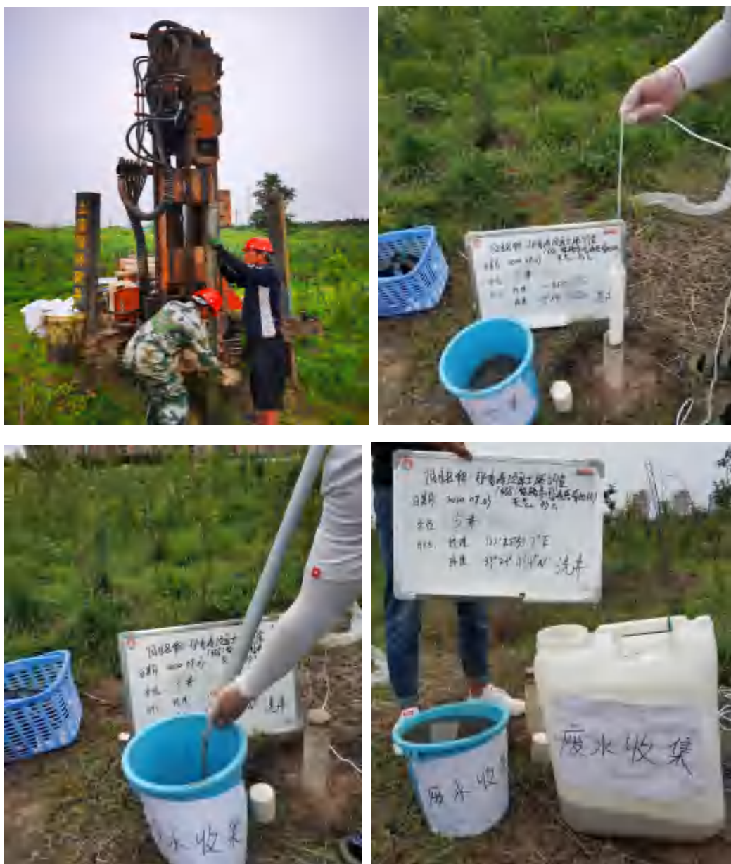
图 6-1 地下水建井、洗井照片
