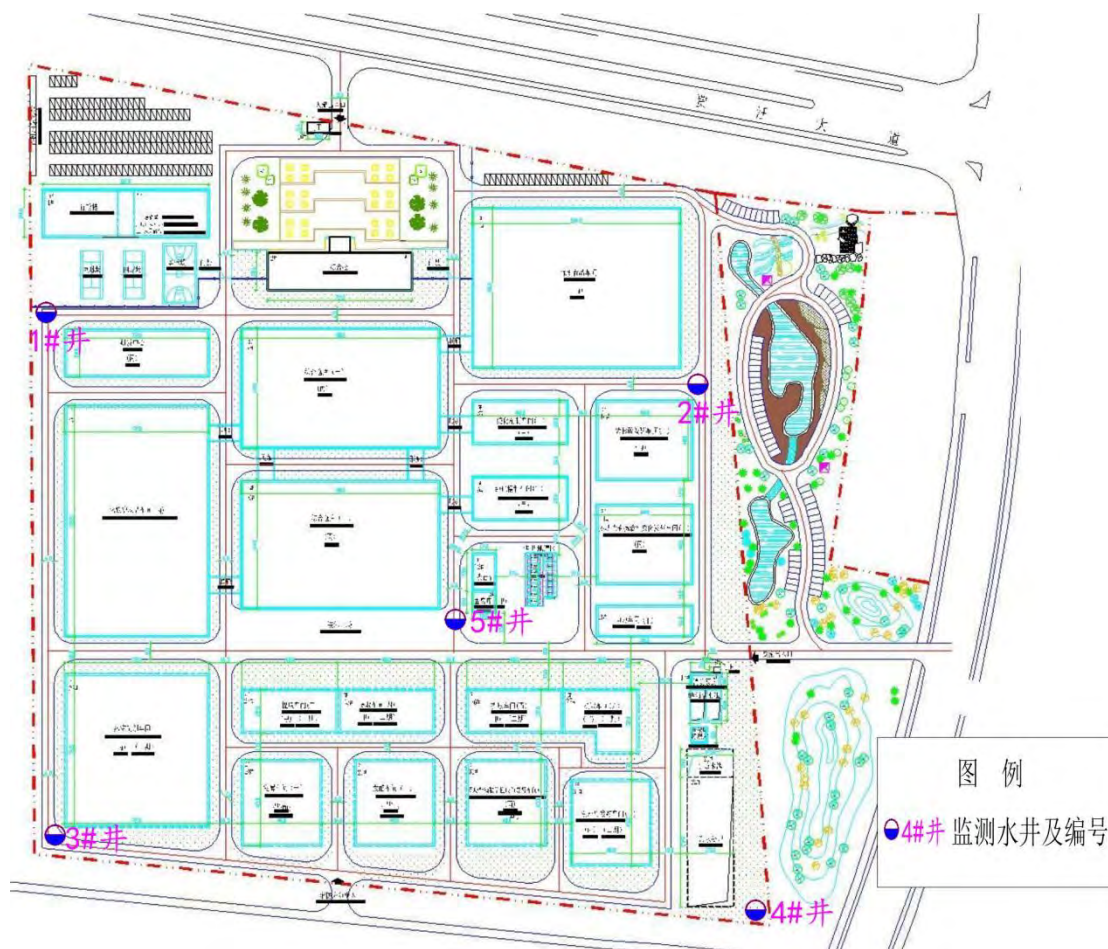
图 5.2.5-38 建设项目场地内监测水井分布图
