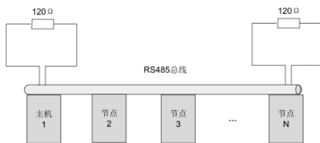
图 8 终端电阻的正确接入方式
