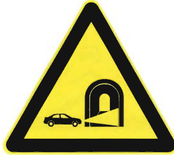
图 61 警 40 隧道开车灯
