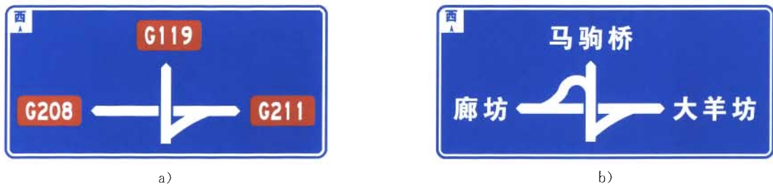
图 198 路 8 互通式立体交叉
