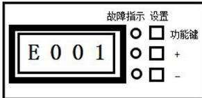
当出现上述现象时说明输入电源至少有一相接触不良或或有故障，此时电焊机没有输出，不能起弧，用万用表交流档分别量取输入电源每相电压看是否正常，如正常在检查输入电源接线是否良好，如良好请联系我们的技术人员
