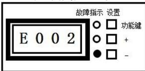
当出现上述故障时说明输入电源至少有一相已经超过了焊机允许的最高输入电压（435V-450V），焊机会自动进入过压保护状态，此时电焊机无输出，不能起弧，请立即停止焊接工作。
