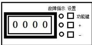
这种情况发生在我公司生产的第一代数字智能电焊机上，故障显示为“0000”，同时电焊机没有输出，电焊机不能起弧，这是因为第一代数字智能电焊机在设置允许输入电压范围时，设置了警告提示，意味着电源的输入电压即将达到允许的最高输入电压。
