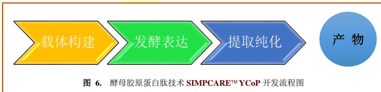
图 6. 酵母胶原蛋白肽技术 SIMPCARE™ YCoP 开发流程图
