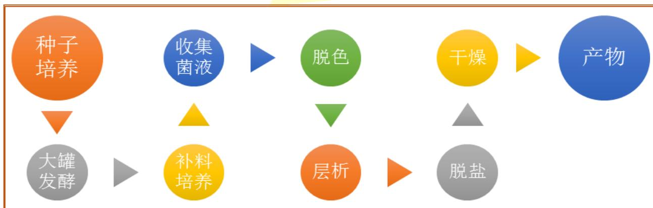
图 8. 生物法酵母胶原蛋白肽 SIMPCARE™ YCoP 生产工艺流程
