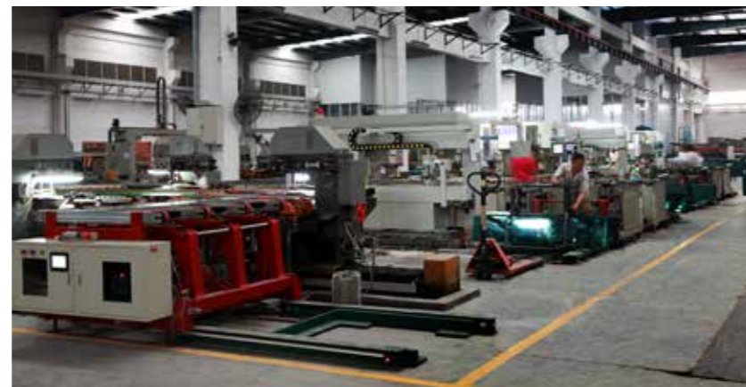
Automated horizontal CNC drilling production line. 全自动卧式CNC钻孔生产线
