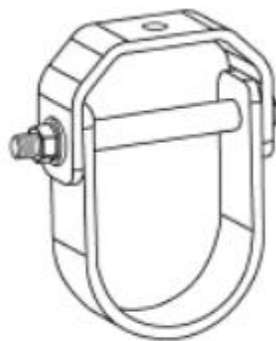
图 C.3 U 型管夹的结构型式示意图
