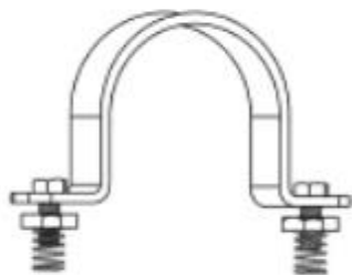
图 C.1 \Omega 管夹的结构型式示意图
