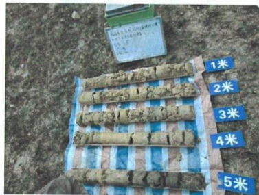
照片 5 S5 土壤柱状图
