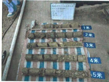
照片 3 S3 土壤柱状图
