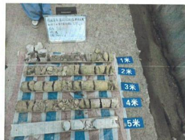
照片 6 S6 土壤柱状图
