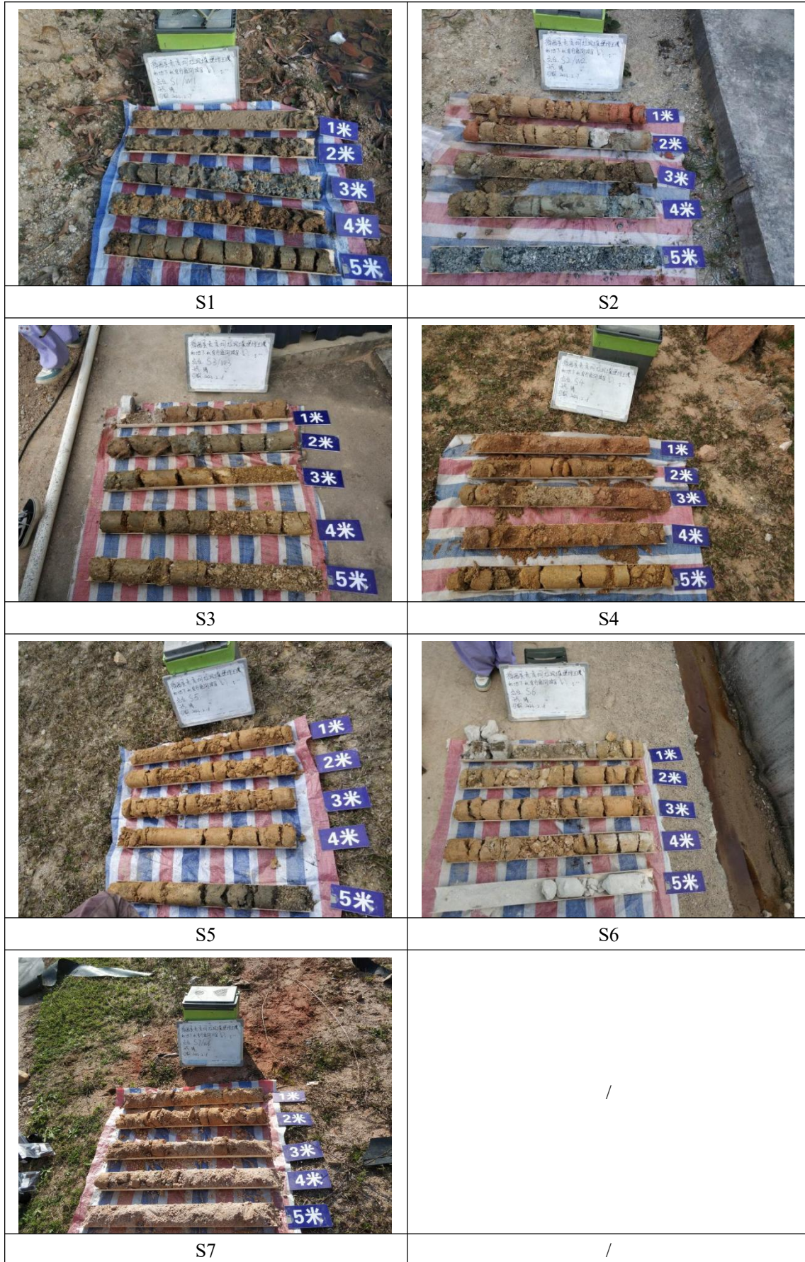
图 4.1.2-2 土壤样品钻孔岩芯图
