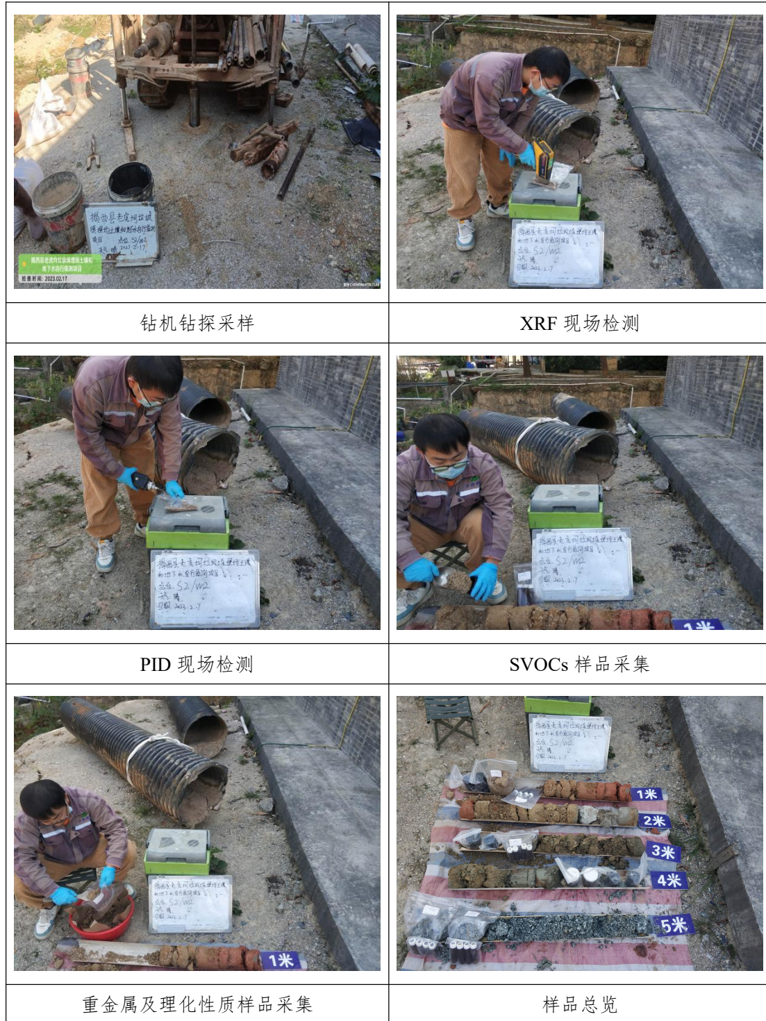
图 4.1.2-1 现场钻探与土壤采样
