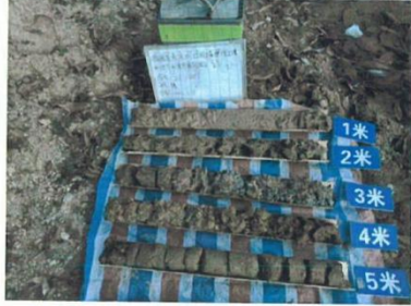
照片 1 S1 土壤柱状图
