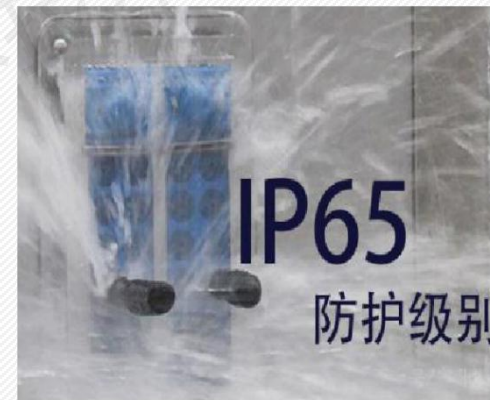
IP65 防水等级，IP2X 防触摸保护
