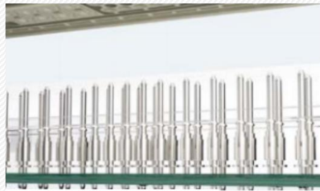
两段式焊接针装配焊接
