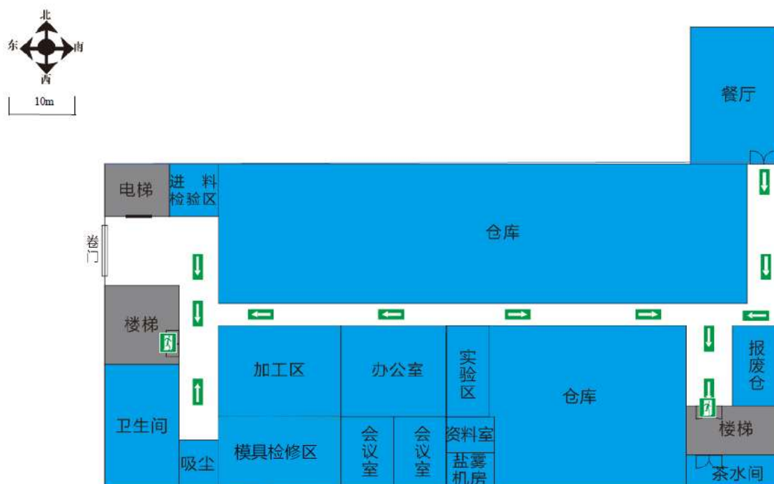
图 3.1-6 平面布局图-七号厂房二楼
