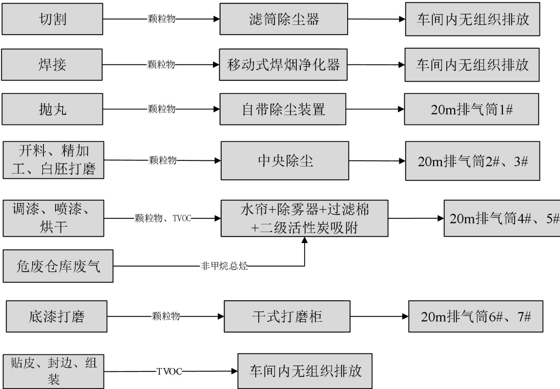
图 4-1 本项目废气收集、处理方式示意图
