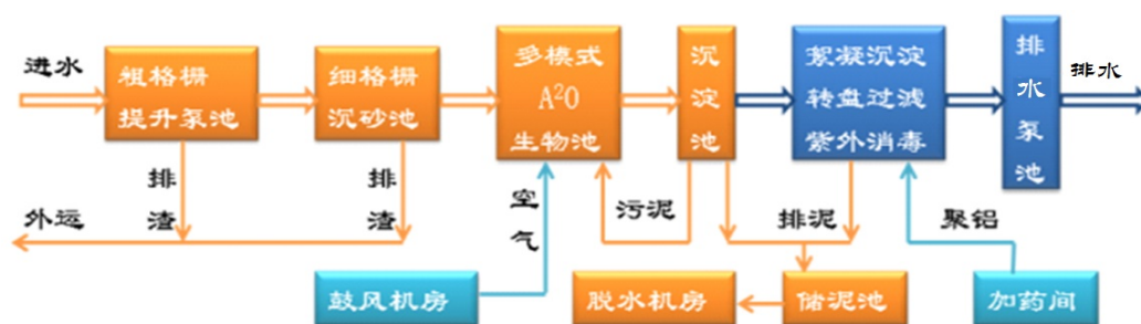
图 4-3 新城区污水处理厂处理工艺流程图
