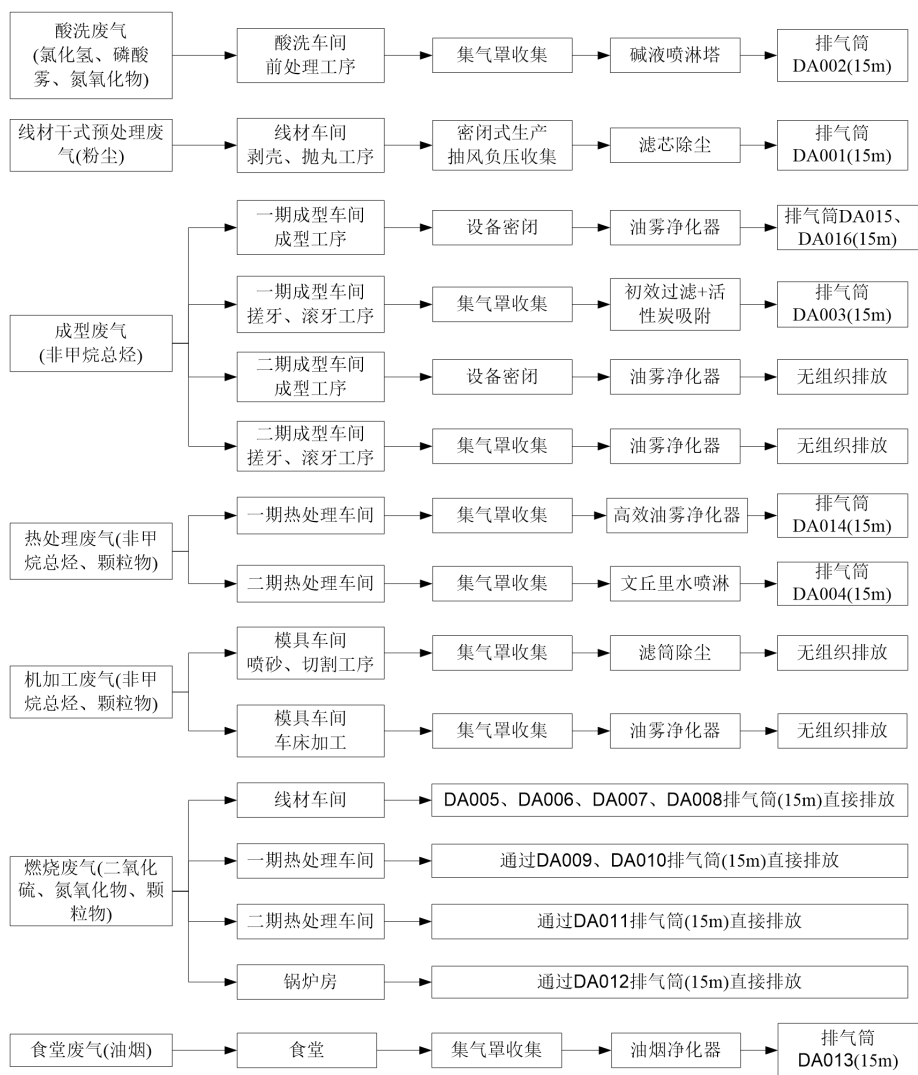
图 4.1-2 全厂废气处理流程图
