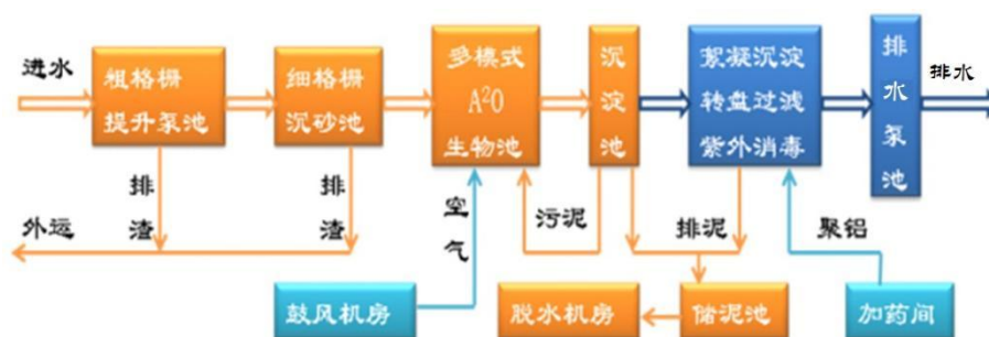
图 4-3 污水处理厂处理工艺流程图
