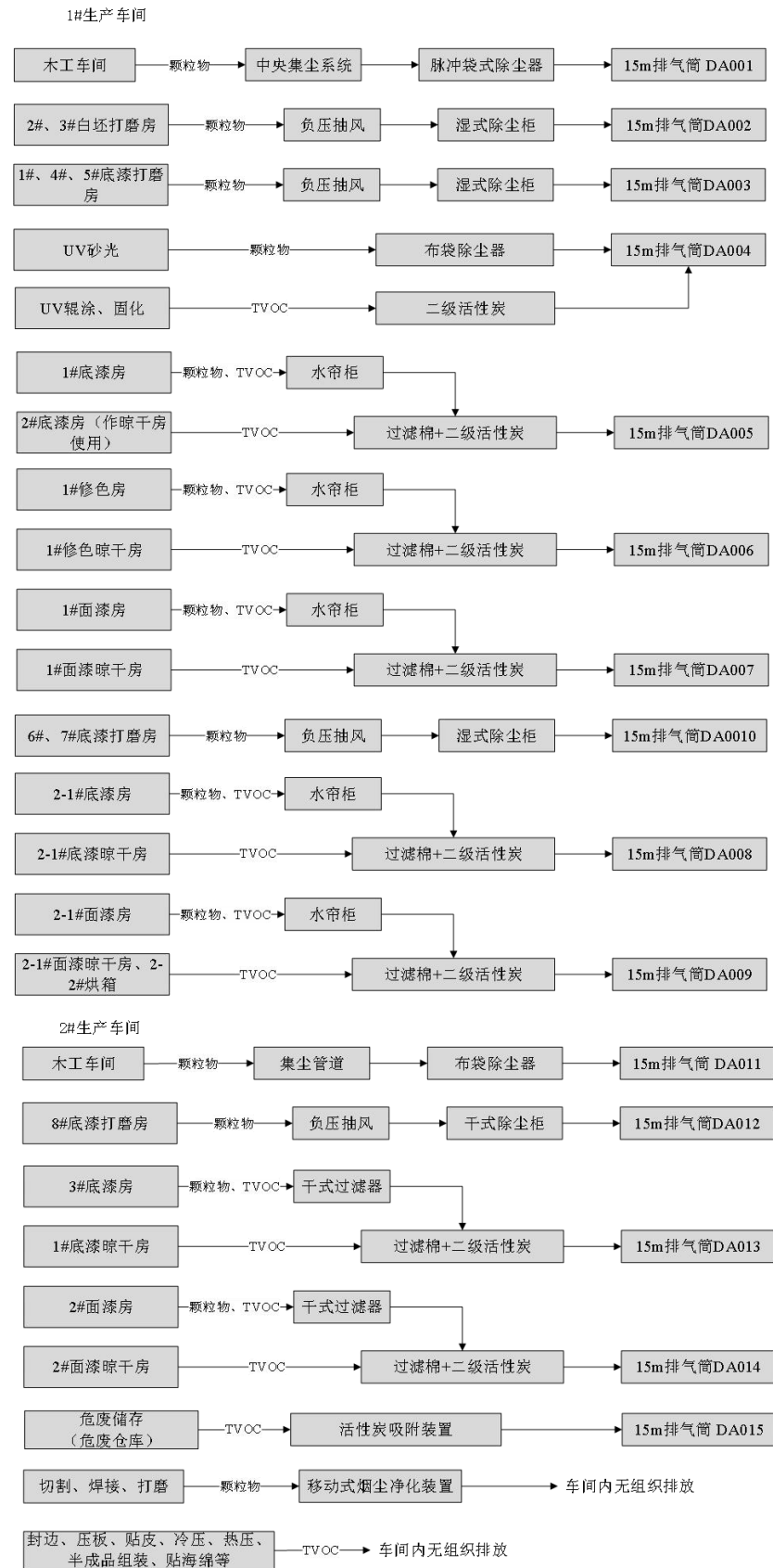
图 4-1 本项目废气收集、处理方式示意图
