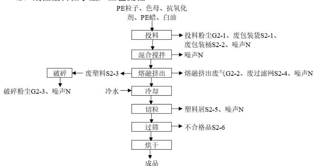
图 2-3 改性塑料粒子生产工艺流程图
