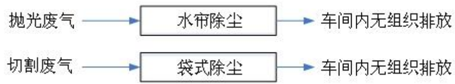
图 4-1 本项目废气收集、处理方式示意图
