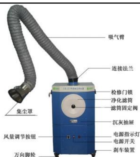
图 4-3 移动式焊烟除尘器结构示意图
