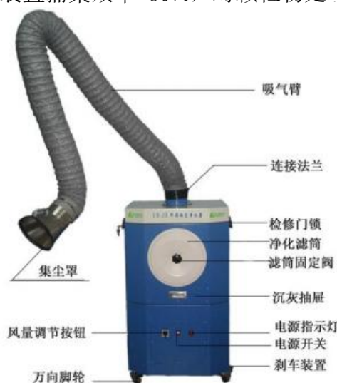
图 4-3 移动式烟尘净化器结构示意图
