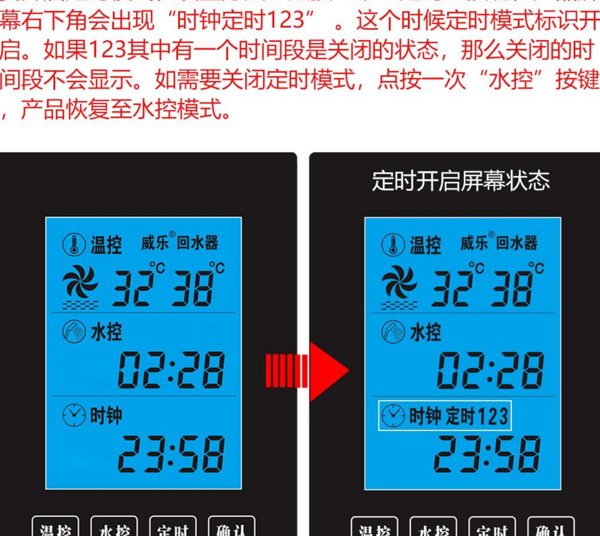
时间段设置完毕只是完成了第一步，所需时间设置完毕后，需要开启定时模式，设置方法：点按一下“定时”按键，产品屏幕右下角会出现“时钟定时123”。这个时候定时模式标识开启。如果123其中有一个时间段是关闭的状态，那么关闭的时间段不会显示。如需要关闭定时模式，点按一次“水控”按键，产品恢复至水控模式。
