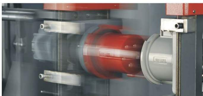
使用寿命测试机 Mating Cycle Life Time Test Machine 测试被测产品接插寿命
