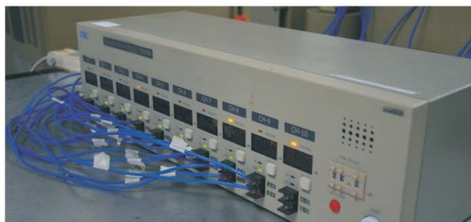
电流瞬断测试仪 Electric Current Break Test Equipment 监测被测产品在震动情况下的通电流情况
