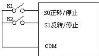
图 5-2 两线式运转模式 1 示意图
