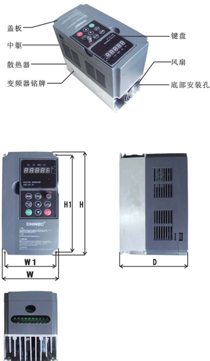
图 2-3 SVF-EV 系列 0.4KW~22KW 壁挂式塑料外壳变频器外形图及外形尺寸示意
