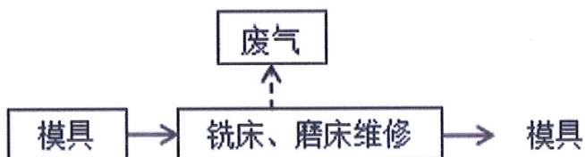
图 2-5 模具维修生产工艺流程及产污环节图
