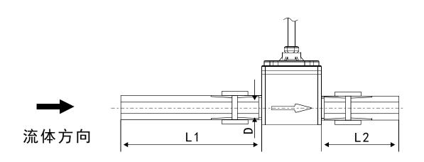
L1: 上流侧, L2: 下流侧, D: 流量传感器内径
