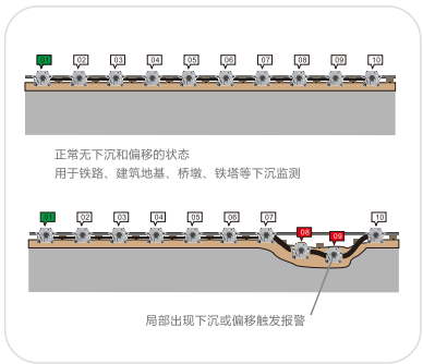
静力水准仪工作原理示意图 可以使用一组采集装置同时采集多个静力水准仪
