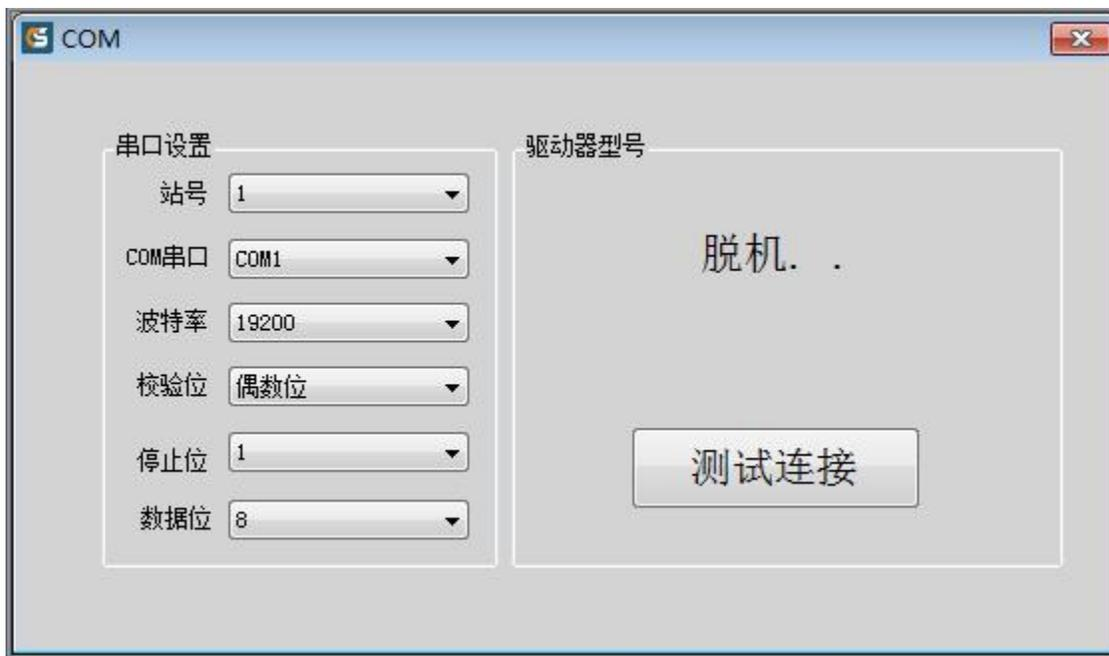
本软件通过计算机的 COM 接口（由 USB 口虚拟而成）与伺服驱动器进行通信。在 COM 界面对一些参数进行设置，根据所用驱动器选择相应的驱动器系列，进行串口设置，其中站号、波特率、校验位、停止位、数据位一般不用改变，保持其默认值即可。
