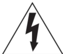
等边三角形内带有箭头的闪电标志，是为了警告使用者本产品内部存在非绝缘的「危险电压」，此电压有造成人员触电的危险。
