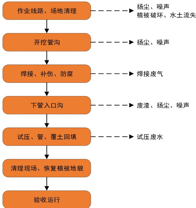
图 2-2 管道施工工艺流程及产污节点图
