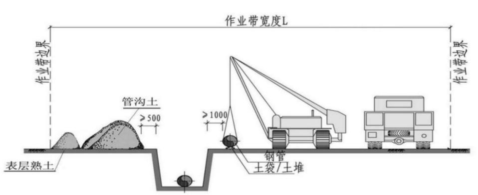
图 2-3 一般地段管道开挖作业示意图
