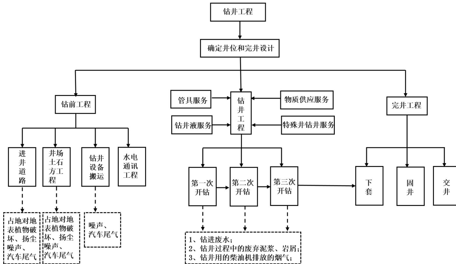
图 2-1 施工期工艺流程及产污节点图
