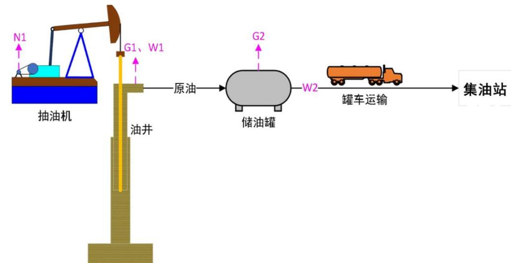
图 2-4 原油开采工艺流程及产污节点图
