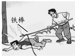
用铁棒挑开通电的裸导线 A
