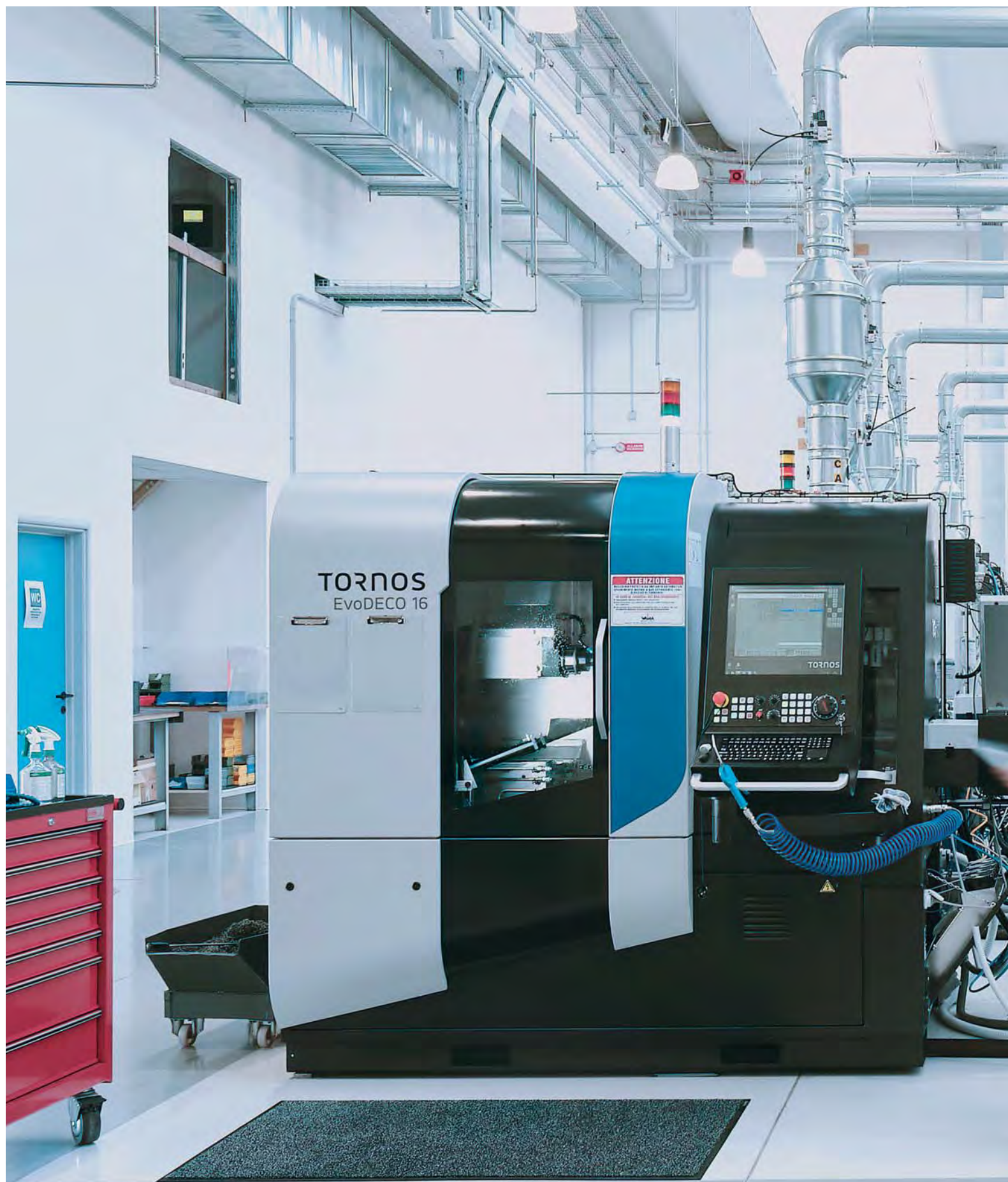
Microprecisione使用托纳斯EvoDECO 16 机床生产类型多样的牙科种植体。
