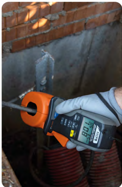
使用钳形表T2100测量接地电阻
