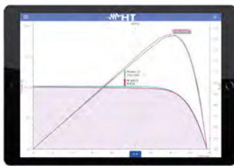
在平板APP上的 I-V曲线和功率曲线。
