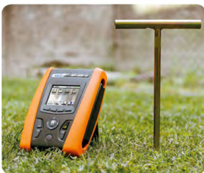
使用伏安法测量接地电阻
