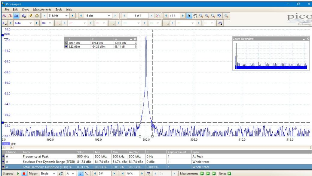
可以使用不同的通道选择和缩放因子来显示多个频谱，并将这些频谱并排放置在相同数据的时域视图旁边。从多个自动频域测量中进行选择，添加到显示中，包括 THD、THD+N、SNR、SINAD 和 IMD。可以将遮罩容限测试应用于频谱，甚至可以一起使用 AWG 和频谱模式来执行扫描量纲分析。
