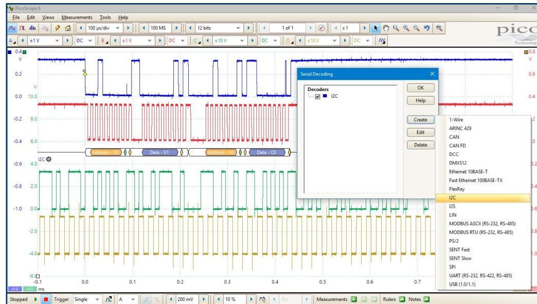
图形格式在公共时间轴上的波形下方, 以计时图表格式显示解码数据 (十六进制、二进制、十进制或 ASCII), 错误帧标记为红色。
