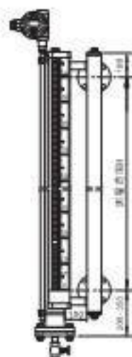
高温负压双腔式带翻柱指示器 图18
