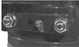
(图4) 机械限位螺栓
