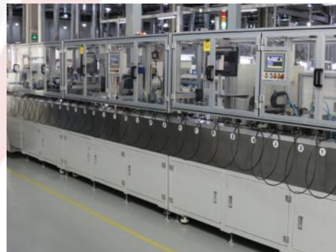
电缆自动铆合影像系统检测
