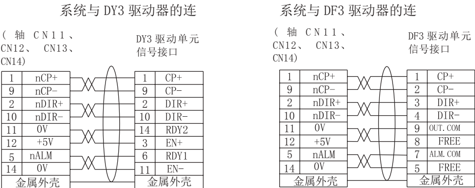
图 2-11 横式 / 竖式车床系统与驱动单元的连接
