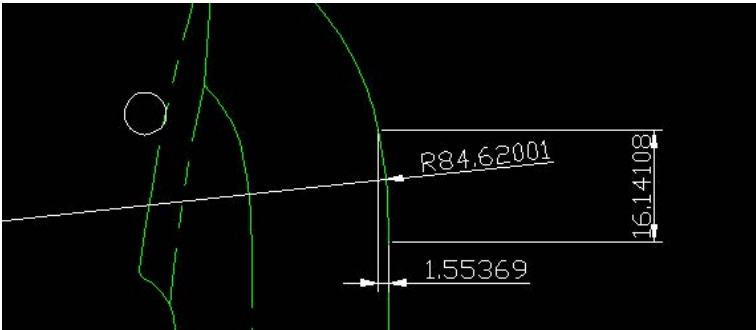
7. 正常加工的第三段圆弧程序，G66 L3 Q-8.36885 P17.47857 R38.46786含义，如下图：
